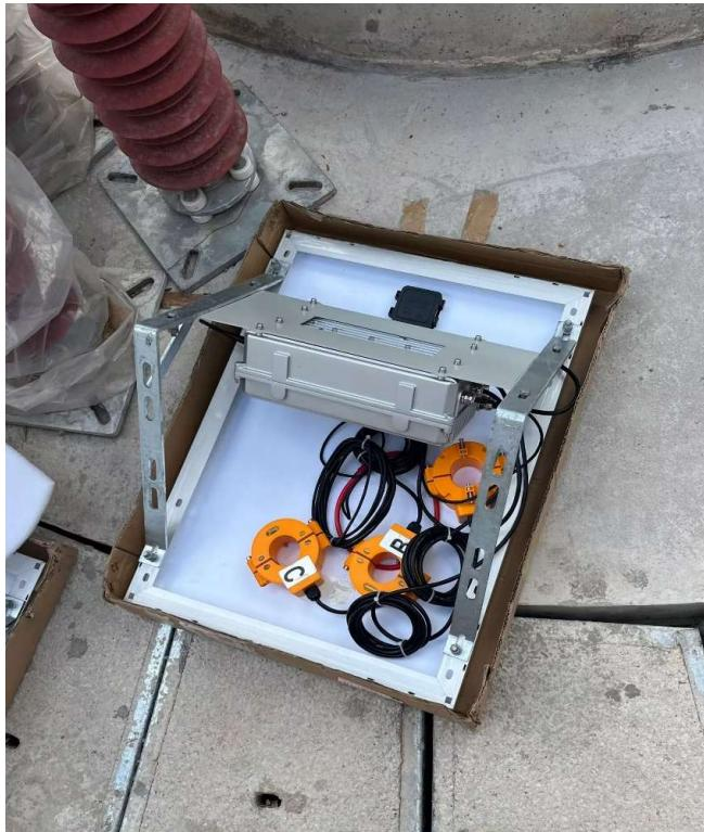
采用精密开合式电流互感器，一次侧单匝穿心，直接将其套在被测电缆的接地线上，或开合式罗氏线圈将其安装在三相电缆上，互感器采用钳形安装方式，不必断开电缆接线，不影响输电线路的正常工作。
